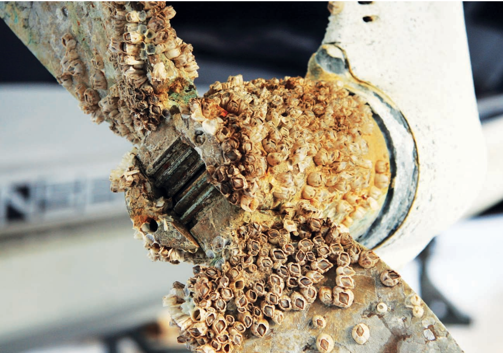
Rurer på propellen bremser fart og gør det sværere at manøvrere. Hvis propellen er udført i en stærk bronzelegering og i øvrigt elektrisk adskilt fra drevet, kan man fjerne zinkanoden og dermed undgå begroning.
